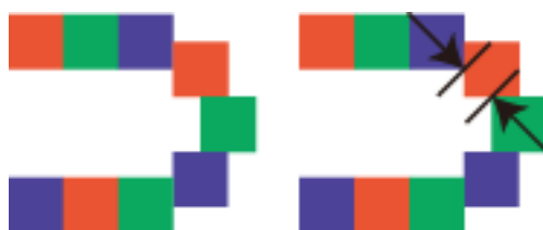
図 1 4 折り返し部分のマージン計算 基準セル幅の 0.7 倍
