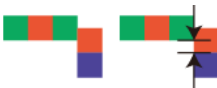
図 1 3 折り返し部分のマージン計算 基準セル幅の 0.5 倍
