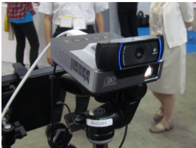
写真1 カラービットを読み取るためのWebカメラ。その下には結果投影用の小型プロジェクターがある
